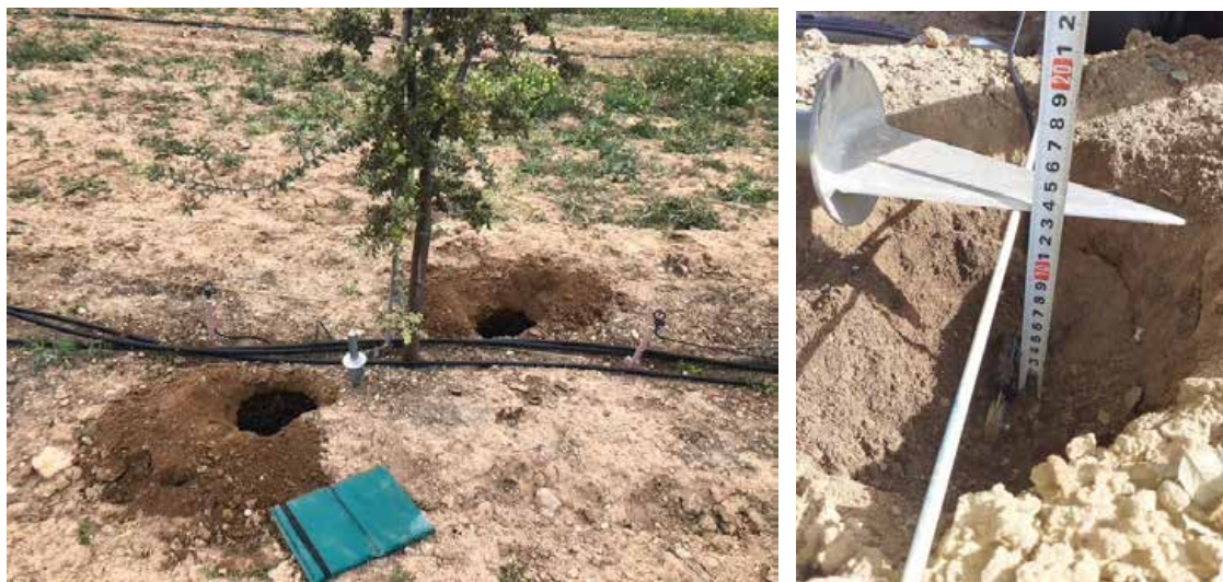
Figures 7 i 8. Unitat experimental amb nius de torba sense barrejar (a l'esquerra) en la plantació. Col·locació de sensors de potencial hídric del sòl en niu on la torba està barrejada amb el sòl (a la dreta).
