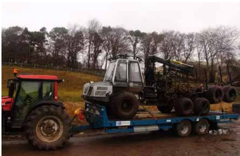
Fotografies 7 i 8. Mida i pes reduïts permeten aprofitar diferents solucions de transport, a l'esquerra amb camió comercial de llarga distància de fusta (aprofitant la tornada amb càrrega de fusta), a la dreta amb remolc agrícola. En ambdós casos la màquina forestal portava un remolc addicional.
