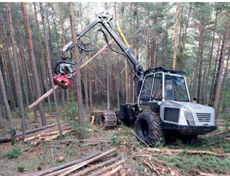
Fotografies 9 i 10. Malwa 560C mode processadora (esquerra) i mode autocarregador (dreta).
