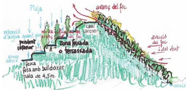
Figura 2. Esquema on s'observa la funció de tallafocs de les feixes. Es tracta de jugar amb camins careners i feixes a contrapendent.
