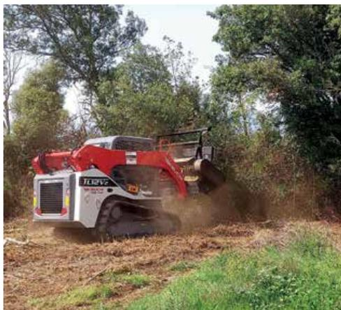
**Fotografía 2.** Takeuchi 110 CV con triturador de martillos fijos.
