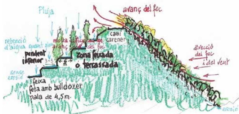
**Figura 2.** Esquema donde se observa la función de cortafuegos de los bancales. Se trata de jugar con caminos cumbreos y bancales a contrapendiente.
