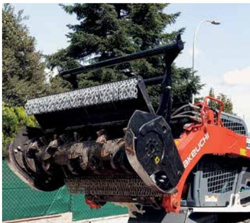
**Fotografía 1.** Takeuchi 110 CV con triturador de martillos fijos.
