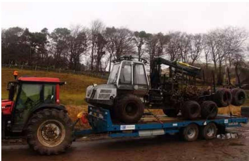
**Fotografías 3 y 4.** Medida y peso reducidos permiten aprovechar diferentes soluciones de transporte, a la izquierda con camión comercial de transporte de larga distancia de madera (aprovechando la vuelta con carga de madera), a la derecha con remolque agrícola. En ambos casos la máquina forestal llevaba un remolque adicional.
