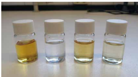
Fotografia 8. Líquids de piròlisi (esquerra) i fraccions finals de sucres, àcids, antioxidants i compostos alifàtics (d'esquerra a dreta), obtinguts de la biorefineria del LIFE BIOEFFORMED.
