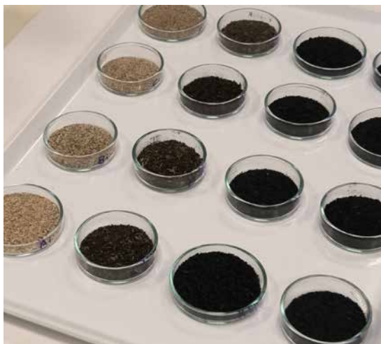
Fotografia 7. Biomassa inicial (part superior) i fraccions sòlides (biochars) a diferents temperatures de 300, 400 i 500 °C (part inferior) de pi pinyer, pi blanc amb branca, pi blanc i alzina (d'esquerra a dreta), obtingudes de la biorefineria del LIFE BIOEFFORMED.
