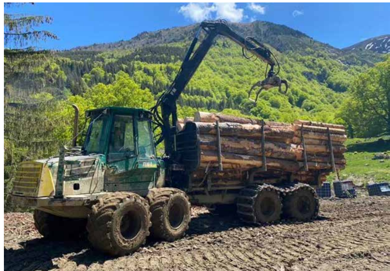
Fotografía 5. Autocargador cargando madera larga longitudinalmente. Autor: Miquel Bautista.
