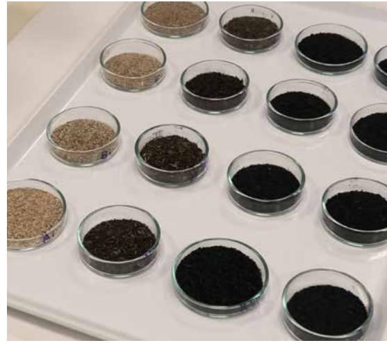
Fotografía 7. Biomasa inicial (parte superior) y fracciones sólidas (biochars) a diferentes temperaturas de 300, 400 y 500 °C (parte inferior) de pino piñonero, pino carrasco con rama, pino carrasco y encina (de izquierda a derecha), obtenidas de la biorrefinería del LIFE BIOEFFORMED.
