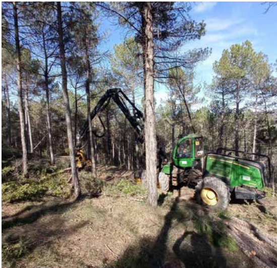
Fotografía 6. Procesadora de cadenas Neuson Forest 264HVT (superior) y procesadora de ruedas (6x6) John Deere 1270e (inferior). Autor: Web de Neuson Forest y Daniel Tarrés.
