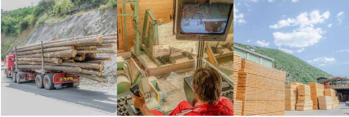
Figura 7. Transporte, dimensionado inicial y preparación de la madera para su transformación industrial.
