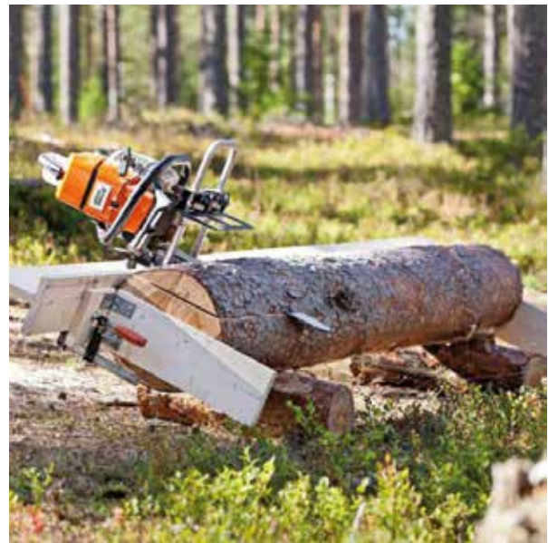
Fotografia 1. Serradora portàtil de cadena Big Mill Timberjig LOGOSOL. Font: https://www.tecnicaforestal.com .
