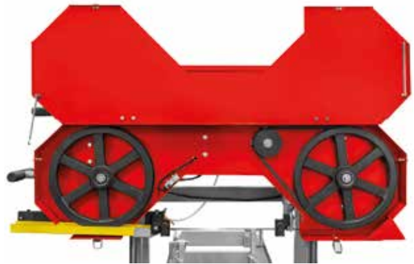
Fotografia 5. Detall de la serra cinta on es poden veure els dos volants que mantenen tensa la cinta i del sistema de transmissió entre el motor i el volant dret. Font: https://www.holzmann-maschinen.at .
