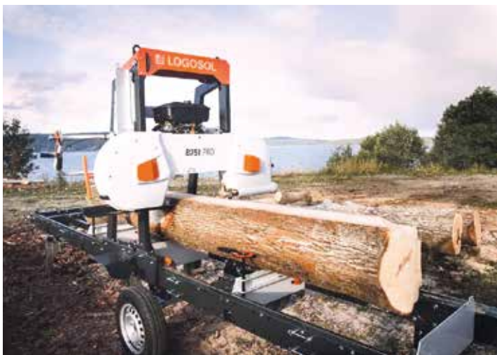
Fotografia 3. Serradora de cinta Logosol B751 PRO muntada sobre un remolc. Font: https://www.logosol.com .
