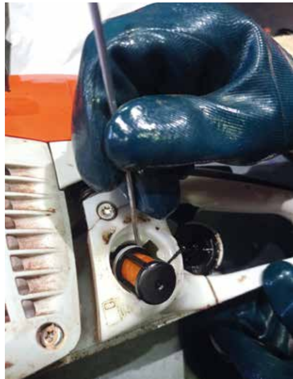
Fotografia 2. Extracció del filtre de gasolina de l'interior del dipòsit. Font pròpia.
