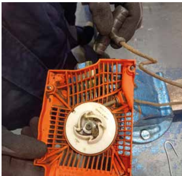
Fotografia 4. Desmuntatge del tiraflexor. Font pròpia.
