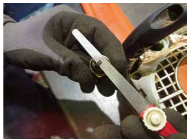
Fotografia 3. Comprovació de la separació dels elèctrodes de la bugia amb una galga. Font pròpia.
