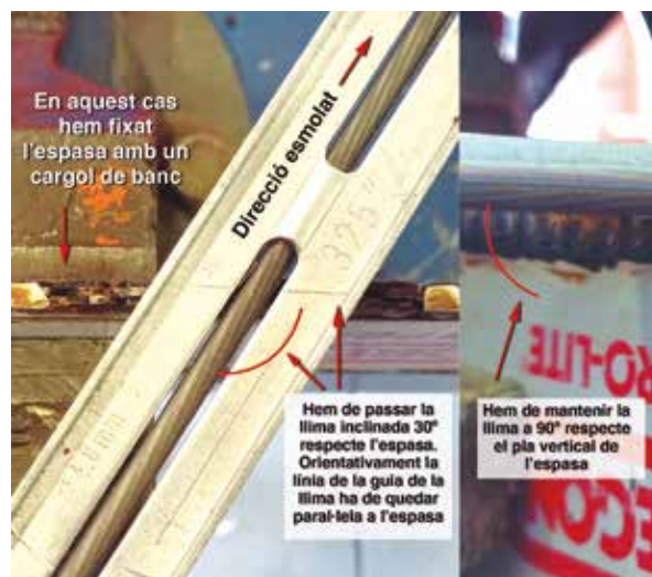
Imatge 2. Posició de la llima en el procés de llimat. Font: Escola Agrària del Solsonès
