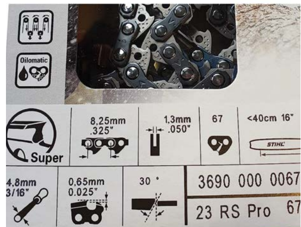
Fotografia 3. Detall de la caixa d'una cadena de motoserra on, a part de trobar informació sobre el pas de cadena, nombre de dents o l'amplada, el fabricant també ens especifica el tipus de llima i angle de llimat que hem de mantenir.
