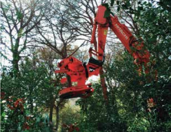
Fotografia 7. Vista d'un capçal de cisalla amb acumulador utilitzat.
