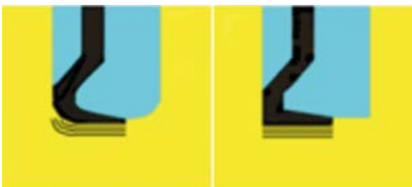
Imatge 3. A l'esquerra detall d'un perfil de dent rodó i a la dreta detall d'un perfil de dent quadrat. Es pot veure que per a un mateix tall, el perfil rodó requereix de més passades que el quadrat (Font: www.oregonproducts.com ).
