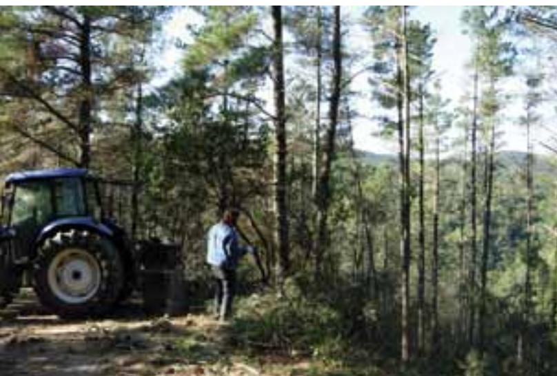
> Fotografia 2. Utilització de tractor amb cabrestant per a l'arrossegament de fusta.
