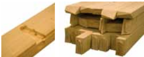
> Fotografia 6. Fabricació automatitzada de peces d'una estructura mitjançant màquina de control numèric pilotada per Cadwork® i detall d'encaixos.
